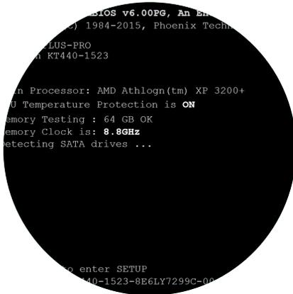
■ تدقيق النظر في بداية تشغيل الجهاز من وصول التغذية الكهربائية وبدء اختبارات الفحص الذاتي (Power On Self Test- POST)، والانتباه إلى العلامات المرئية على الشاشة ورسائل الخطأ المكتوبة والمسموعة؛ للتأكد من عدم وجود خلل.
