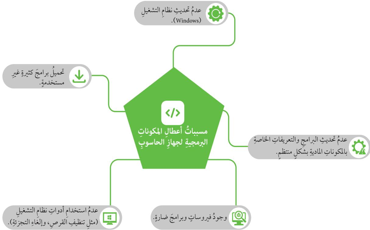
الشكل (1-3): أسباب أعطال المكونات البرمجية لجهاز الحاسوب
